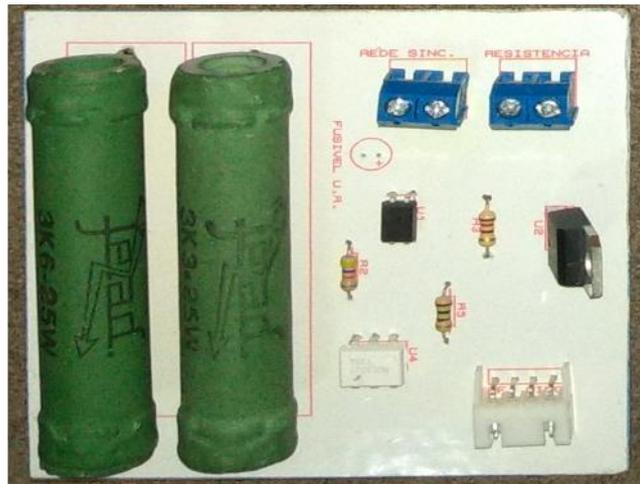
**Figura 6 - Placa de Sincronismo e Acionamento**
