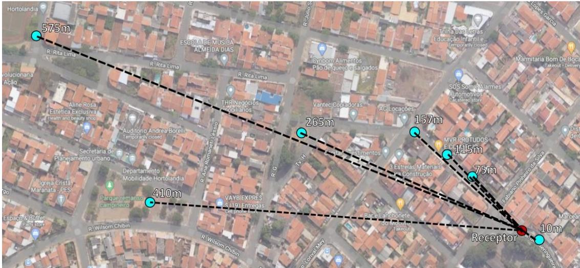
Figura 5 – Ensaios Experimentais para Determinação do Alcance da Rede LoRa.
